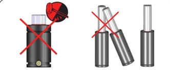
Preservar de golpes en el cuerpo o en el vástago del cilindro. Cualquier imperfección puede ocasionar una pérdida de presión y afectar a la vida útil del cilindro. Manipular y transportar los cilindros de manera que no se golpeen entre sí. Si un cilindro presenta desperfectos en su estructura descargar completamente de gas antes de proceder a su revisión o manipulación.
