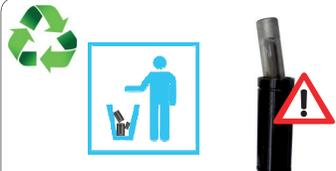
Acabada la vida de servicio del cilindro, descargar completamente. El vástago debe quedar completamente introducido en el cuerpo. En caso de cualquier daño estructural del cilindro, descargar completamente toda presión residual antes de manipular.
