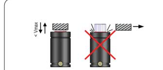
Prevenir la liberación repentina del vástago del cilindro para evitar descargas o daños de los componentes. No superar la velocidad máxima indicada para cada modelo. Si en una revisión del troquel y los cilindros, se encuentran tornillos rotos o aflojados, podría indicar que se ha producido una liberación libre, por lo que conviene reemplazar el cilindro y eliminar la causa.
