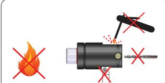
Cualquier operación mecánica (mecanizado, taladrado, soldaduras, etc) sobre el cilindro queda totalmente prohibida. No acercar ninguna llama o fuente de calor.
